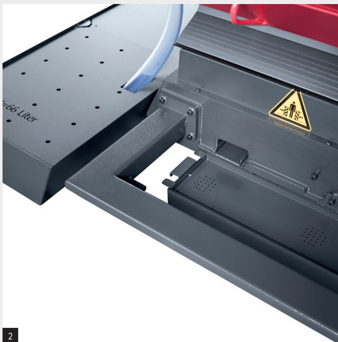
Manuelles Handrad X-Achse (1), Ölauffangwanne und Kühlmittelbehälter (2), Spritzschutz (3)
