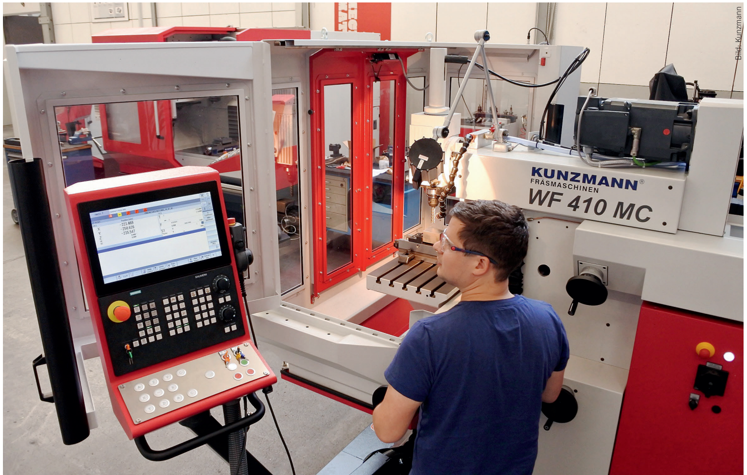
Im Handbetrieb können die Türen beim Bearbeitungsprozess geöffnet bleiben.
