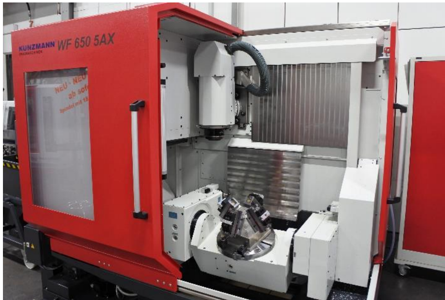
Die WF 650 5AX mit neuer 18 000-U/min-Spindel (Bildquelle Kunzmann)
