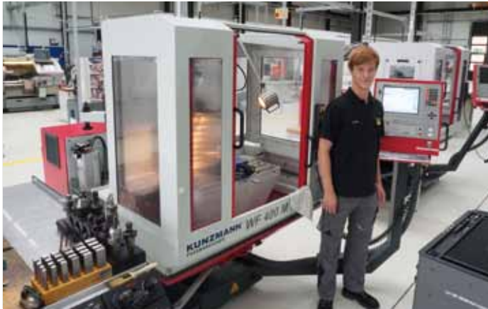
Seit 2015 setzt Viega in der Ausbildung auf Fräsmaschinen von Kunzmann, hier eine hochpräzise konventionelle Fräsmaschine des Typs WF 400 M.
