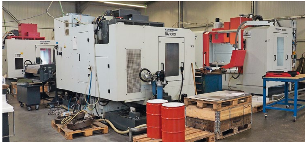
Zehn Kunzmann-Bearbeitungszentren des Typs BA 1000 und – für größere Werkstücke – des Modells BA 1400 stehen in der Fräshalle der Firma Zerspanungstechnik Schmidt.
